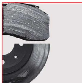
**APARÊNCIA** O material de fricção inclui partes de metal do disco.
